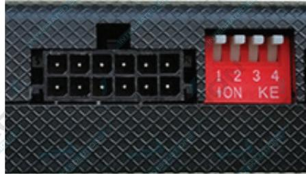
Collegare il connettore 12 poli del cavo radio all'interfaccia video.
